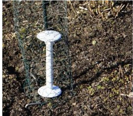
Klimalogger mit Schutzhülle aus Maschendraht
